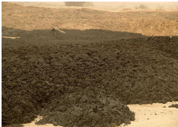
الشكل 8-16: تقنية التجفيف الطبيعي لمعالجة الحمأة.
