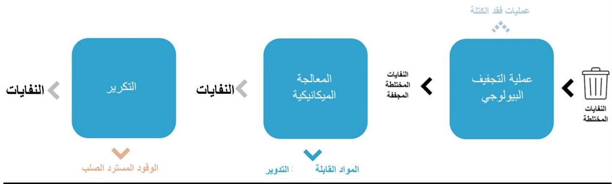
الشكل ٦-٠: مخطط عملية سير التكرير للمعالجة الميكانيكية البيولوجية - الخيار الثاني.
