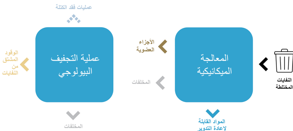
الشكل ٦-٠: مخطط عملية سير التجفيف البيولوجي للمعالجة الميكانيكية البيولوجية - الخيار الأول.
