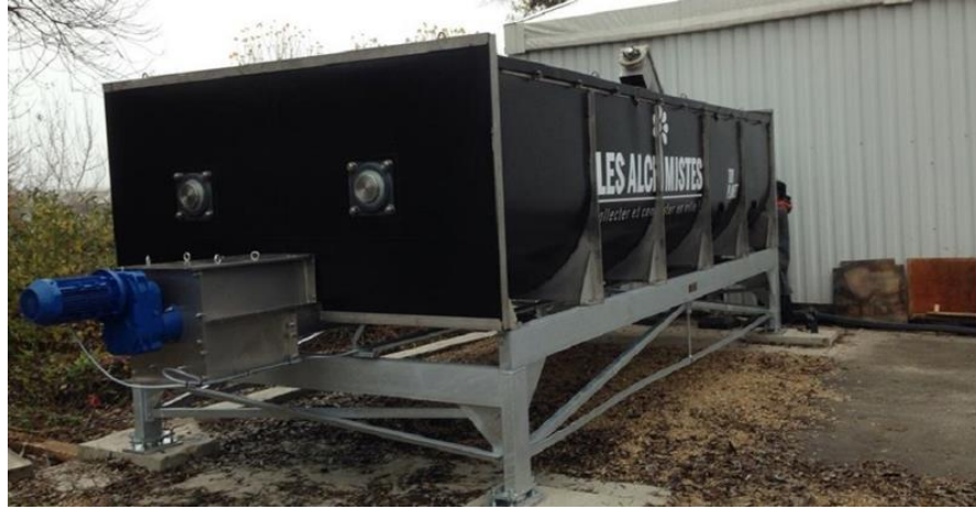
الشكل ٦-٠٠: مثال لنظام التسميد في الحاويات - نظام Rocket Composter B١٤٠٠
