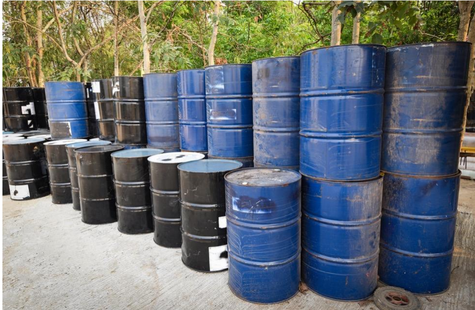
الشكل ١-٠: براميل مخزنة في شكل صف بدون ملصقات كافية ودون حاويات ثانوية أو فواصل حريق كافية.
