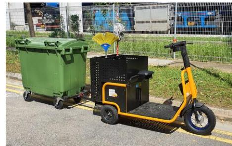
الشكل ٦-٢: مركبات جمع النفايات الكهربائية الصغيرة.
