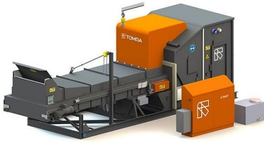
الشكل 6-17: مثال على تقنية إرسال الأشعة السينية.
